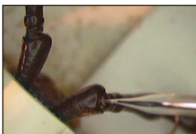
Foto 3: Detalle de inserción de electrodo de referencia en antena de C. welensii .
